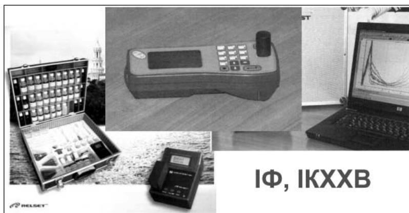
Рис. 6. Портативна спектрометрична лабораторія «АКВА-ТЕСТ» для аналізу питної води
