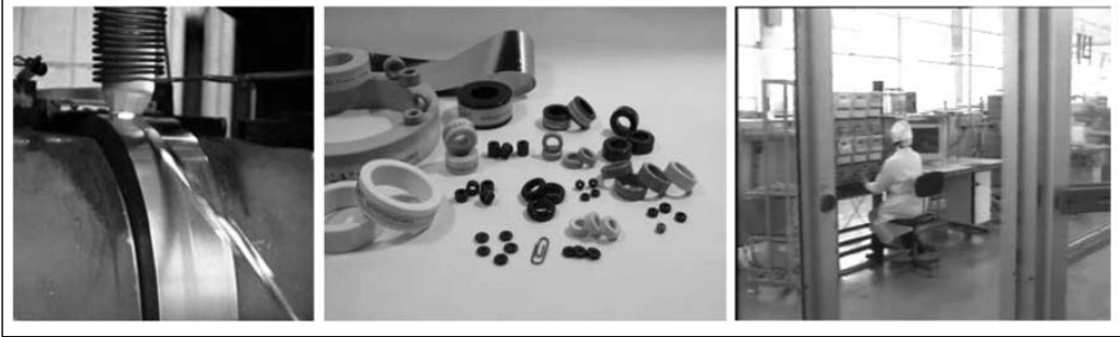
Рис. 7. Зліва направо: обладнання для виготовлення нанокристалічної магнітної стрічки; магнітні осердя з нанокристалічних матеріалів; виробнича дільниця
